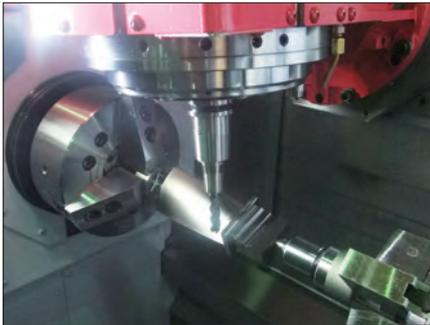
複合加工機によるタービンブレード加工
